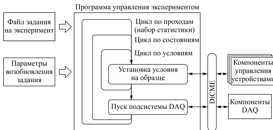
Рис. 9. Схема работы программы управления экспериментом
