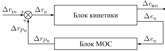
Рис. 3. Основная структурная схема математической модели импульсного реактора ИБР-2М в режиме саморегулирования с учетом только мощностной обратной связи (МОС): \Delta r_3 — задающая реактивность
