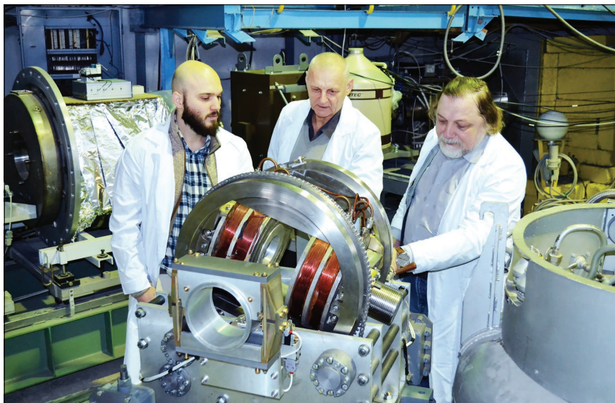
Электромагнит с автоматизированным управлением для создания внешнего магнитного поля, приложенного к образцу. Слева направо: В. Д. Жакетов, Ю. В. Никитенко, А. В. Петренко.
