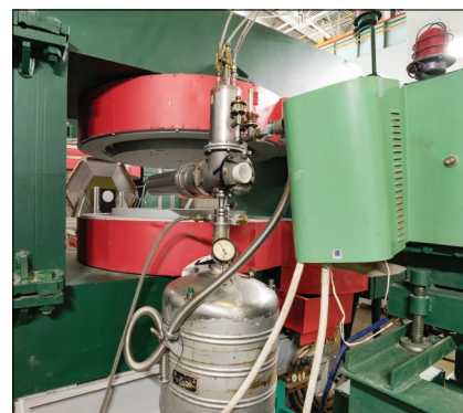
Жидководородная мишень для эксперимента SRC: дюз с жидким азотом для охлаждения, сверху, внутри горизонтального «пальца» находится жидкий водород.
