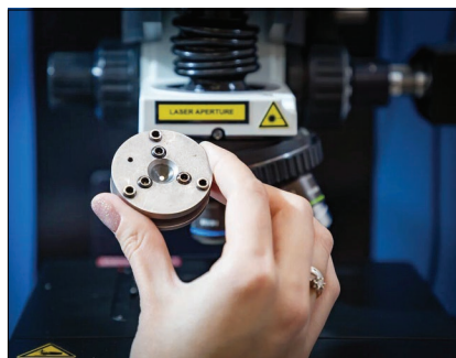
Камера высокого давления с алмазными наковальнями для создания высокого давления на образце.
