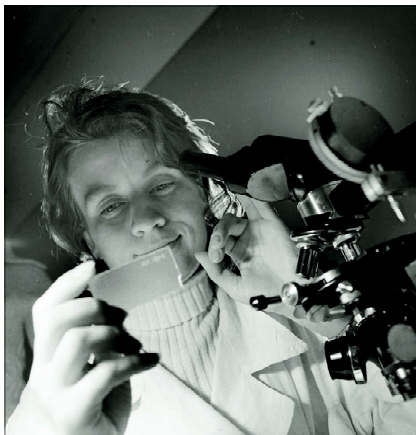
Трековые мембраны начинались с детекторов. Светлана Павловна Третьякова просматривает стеклянный детектор на оптическом микроскопе (1969 год).
