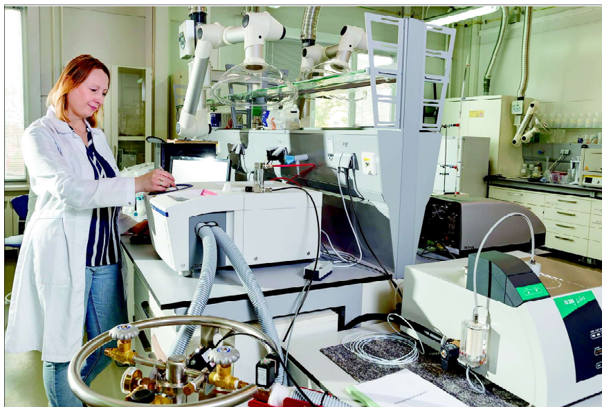
Исследование термических свойств мембран на дифференциальном сканирующем калориметре проводит Катажина Олейничак (Польша).
