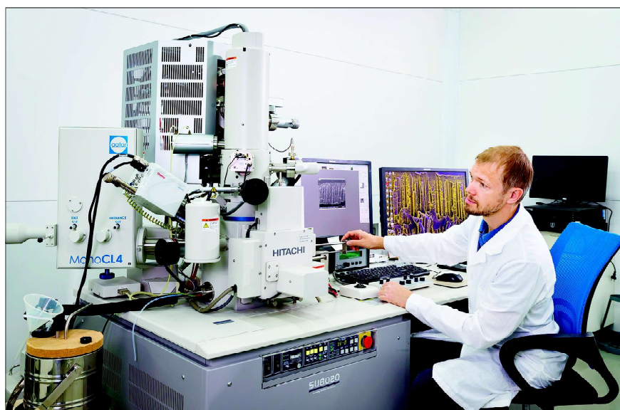
Николай Лизунов исследует структуру трековой мембраны на растровом электронном микроскопе Hitachi SU8020.
