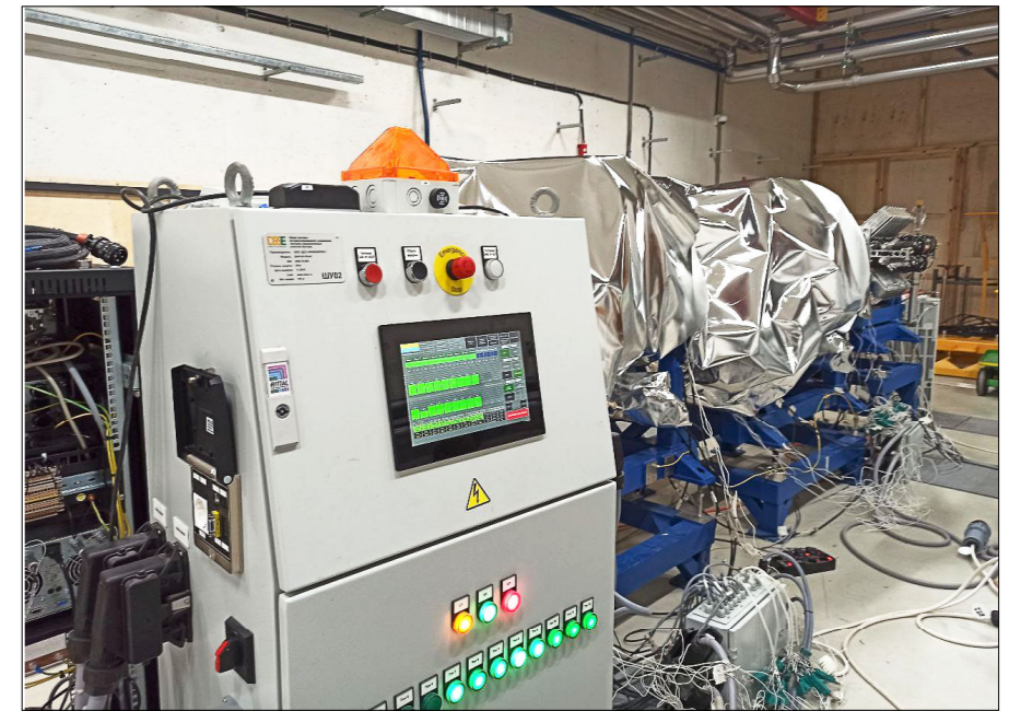
Процесс прогрева. На монитор выводятся показатели температуры на разных участках
